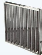
El principio de filtración en este caso es de impactación por inercia. La velocidad del flujo de aire es de 300 PPM y las partículas de grasa en suspensión se impactan por inercia al cambiar el sentido de dicho flujo dos veces en 180°. También se lavan en lava-loza o con lavadora de presión
